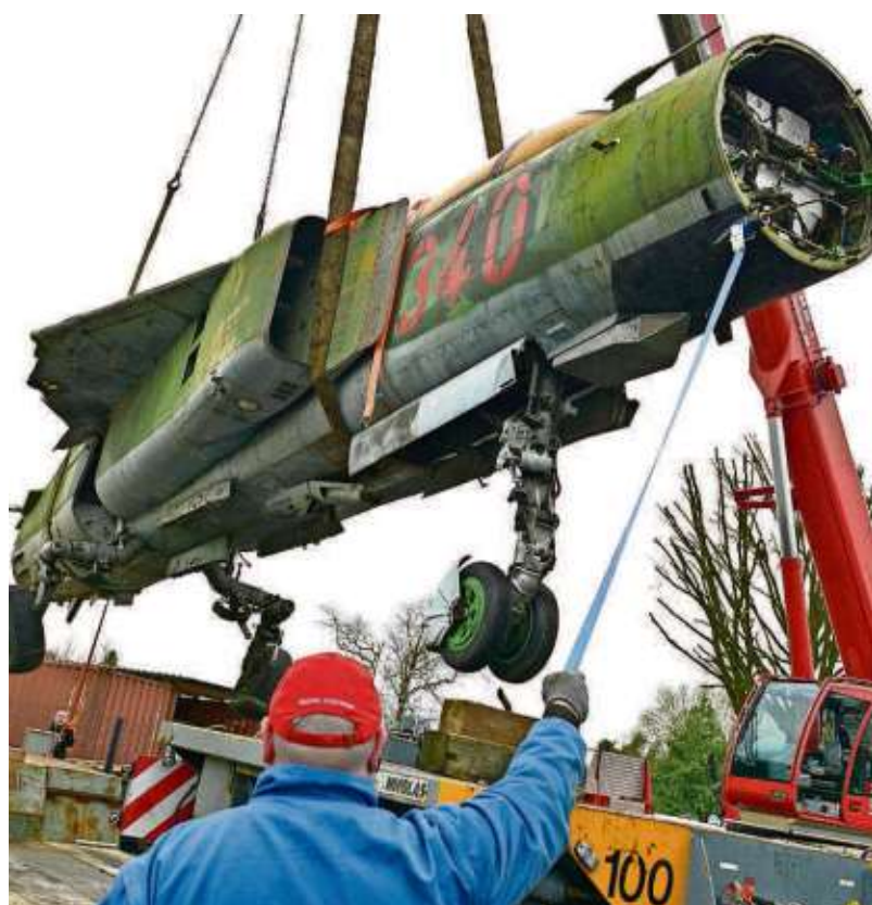
Eine alte MiG 23 schwebt in der Luft. Vorsichtig wird das gut erhaltene Kampfflugzeug mit dem Kran vom Laster gehoben.
