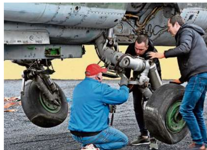
Die Fahrwerke, die für den Transport nach innen geklappt worden waren, müssen jetzt wieder verändert werden.
